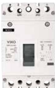
Автоматические выключатели в литом корпусе серии VMT-SN2 обеспечивают термомангнитную защиту при отключающей способности 35 и 50 кА в диапазоне от 40 до 800 А. Благодаря возможности регулировки уставки теплового расцепителя автоматического выключателя, возможно изменение диапазона номинального тока от 0,7 до 1.
