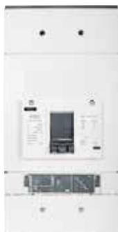
Серия автоматических выключателей в литом корпусе VME-SN2 обеспечивает превосходную защиту при отключающей способности 65 и 70 кА в диапазоне от 800 до 1600 А. Настройки устройства выполняются переключателями, расположенными в нижней части автоматического выключателя.
