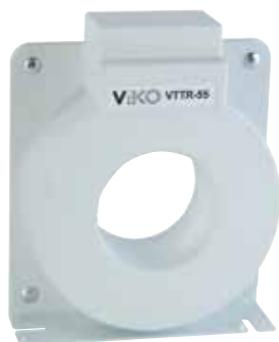
Тороидальный трансформатор тока считывает разницу между входящим и выходящим током. Он обнаруживает возможную утечку тока в системе вместе с Реле контроля тока утечки
