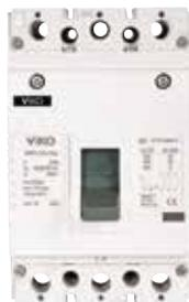
Автоматические выключатели в литом корпусе серии VMF-SN2 обеспечивают термомангнитную защиту при отключающей способности 25, 35 и 50 кА в диапазоне значений номинального тока от 40 до 800 А. Имеют фиксированные тепловые и электромагнитные параметры.
