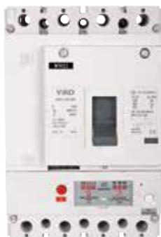
Серия автоматических выключателей в литом корпусе VMR обеспечивает термомангнитную защиту и защиту от тока утечки при отключающей способности 25, 35 и 50 кА в диапазоне значений от 50 до 500 А. Данный тип устройства имеет возможность настройки параметра значения тока утечки 100, 300 и 500 мА, в дополнение к фиксированному типу автоматического выключателя. Настройки устройства осуществляются с помощью переключателей, расположенных в нижней части автоматического выключателя.
