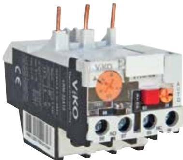
В случае перегрузки тепловое реле защищает трехфазный асинхронный двигатель. Они устанавливаются совместно с контакторами. В то время, как автоматические выключатели обеспечивают защиту при определенном значении тока, тепловые реле обеспечивают защиту в регулируемом диапазоне тока.
