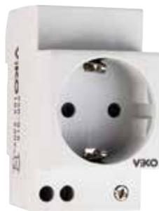
Модульные розетки на DIN-рейку предназначены для щитового монтажа, для временного подключения электрооборудования.
